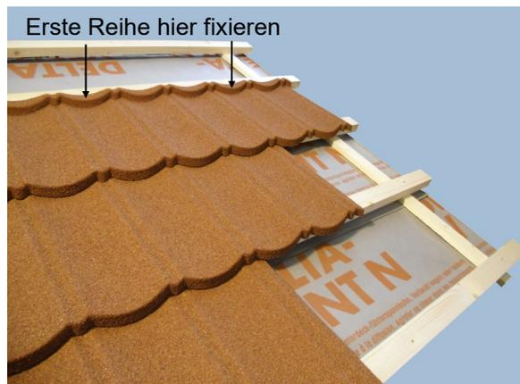
Die Verlegung beginnt immer oben am First bzw. am Pult in der ersten Reihe ganzer Dachplatten. Fixieren Sie die Platten am oberen Rand mit Nägeln. Wurde die oberste Dachplattenreihe gekürzt, (wie auf Seite 3 Abb. unten rechts), beginnen Sie mit der 2. Reihe. Achten Sie besonders auf die korrekte Seitenüberdeckung!
