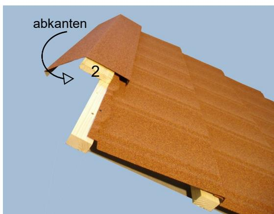
Der Pult benötigt ein Auflagebrett (2). Der Winkel der Pultkappen-Schenkel wird je nach Bedarf durch Abkantung (per Hand möglich) abgepasst.
